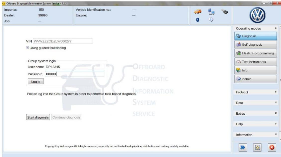
После входа в систему токены для подключения SFD, необходимые для работы с блоками управления, автоматически запрашиваются в фоновом режиме.
