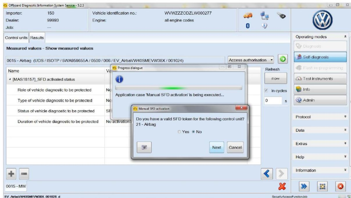
Для создания токена на сервере SFD потребуется структурированный запрос на подключение, сгенерированный блоком управления. Эту структуру можно скопировать в буфер или сохранить в файле:
