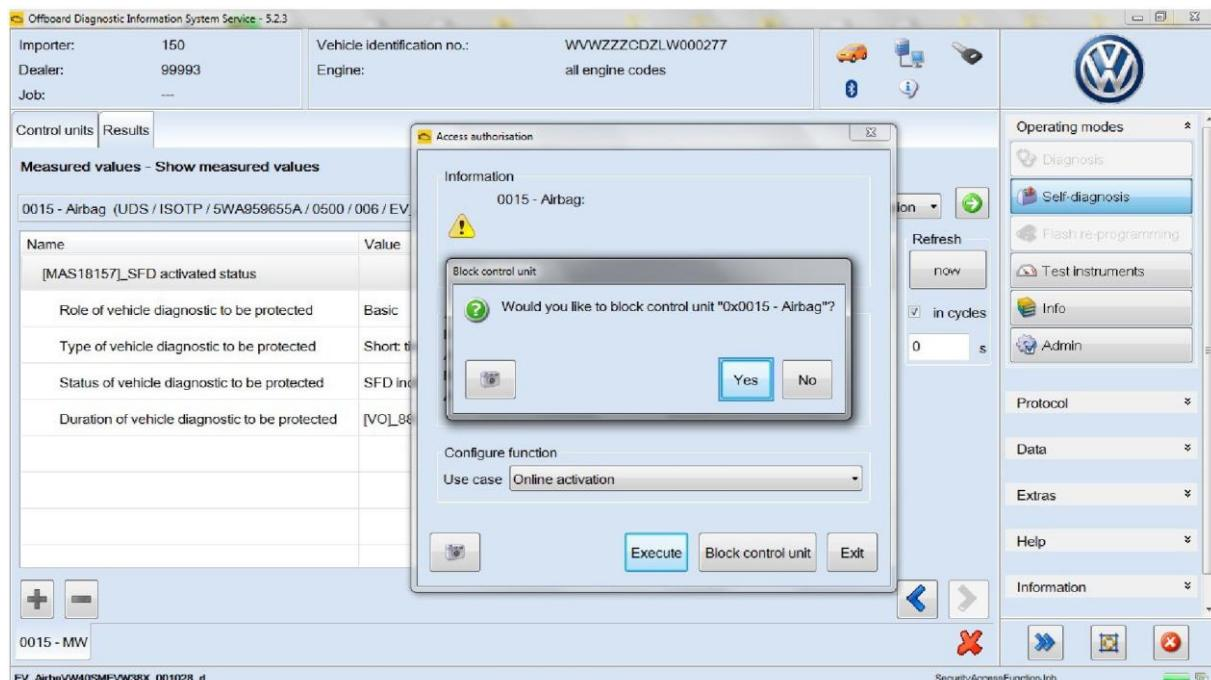
После этого статус подключения показывает, что доступ к блоку управления закрыт. Подключение можно выполнить повторно:
