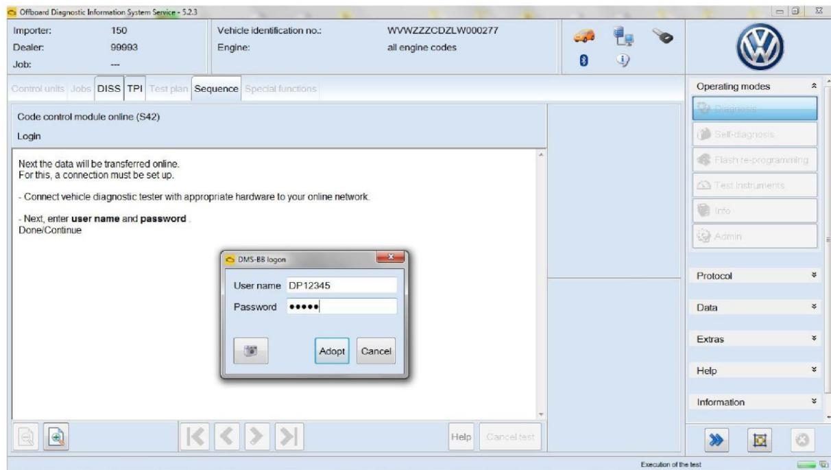
Блок управления подушек безопасности, защищённый SFD, автоматически открывается для записи, и кодирование проходит успешно (Coding of the system Airbag successful).
